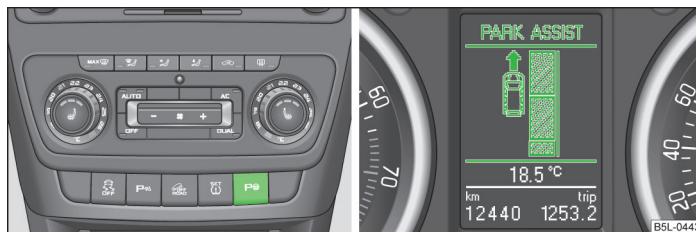
Obr. 120 Zapnutí zobrazení parkovacího asistentu na informačním displeji / Informační displej: vyhledání vhodné mezery pro zaparkování
