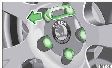
Obr. 164 Stažení krytky šroubu kola
