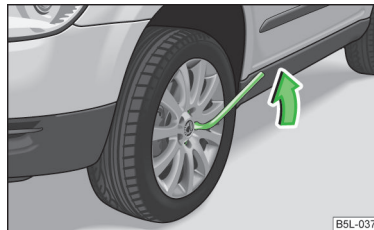
Obr. 169 Výměna kola: povolení šroubů
