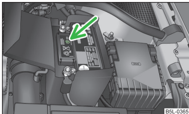
Obr. 159 Akumulátor: ukazatel hladiny elektrolytu
