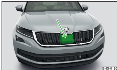
Obr. 263 Umístění radarového snímače
