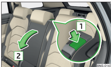
Obr. 94 Sklopení zádové opěry prostředního sedadla
