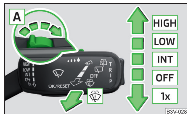
Obr. 81 Ovládání stěračů a ostřikovačů čelního skla
