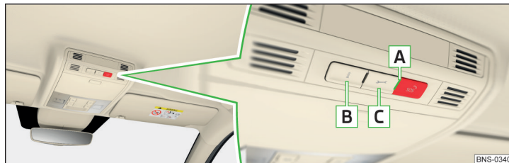
Obr. 12 Tlačítka a kontrolní světlo služeb Care Connect
