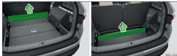
Obr. 161 Vyjmutí přepážky: pětímístná varianta/ sedmimístná varianta
