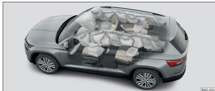
Obr. 22 Plynem naplněné airbagy
