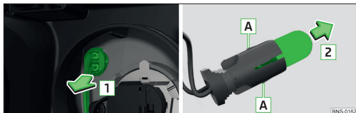
Obr. 372 Výměna žárovky obrysového světla
