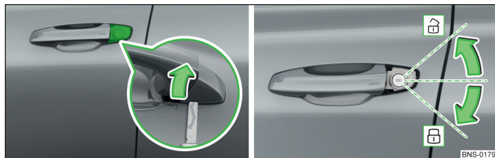
Obr. 356 Klikla dveří řidiče: odklopení krytu zámku / odemknutí a zamknutí
