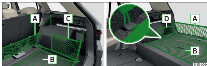
Obr. 144 Příklady upevnění sítí: pětímístná varianta / pětímístná varianta s mezipodlahou
