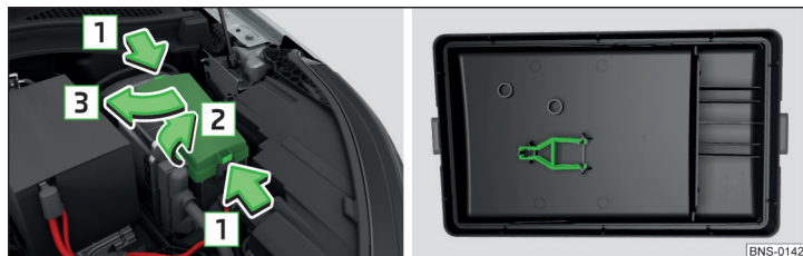
Obr. 368 Kryt pojistek: vyjmutí krytu / plastová svorka na pojistky
