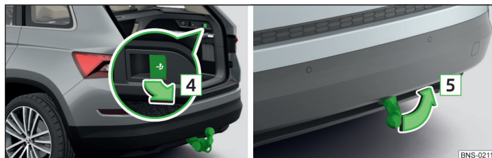
Obr. 317 Tažné rameno: zaklopení
