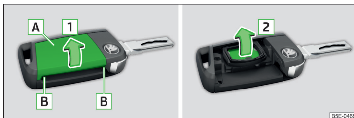
Obr. 351 Odklopení krytu / Vyjmutí baterie
