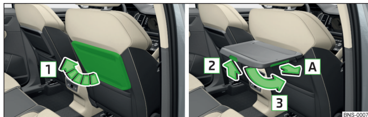
Obr. 129 Vyklopení stolku / Sklopení stolku a vysunutí držáku nápojů
