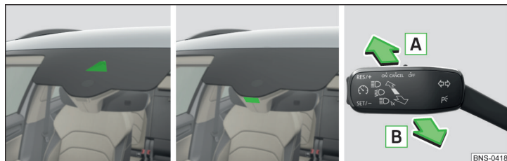
Obr. 71 Varianty umístění snímače / Zapnutí/vypnutí systému
