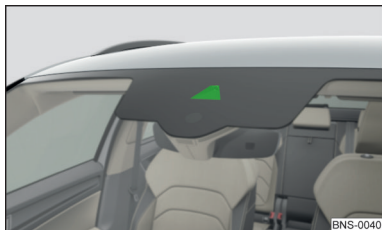
Obr. 309 Snímač pro Lane Assist
