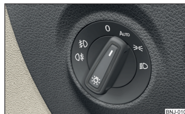
Obr. 43 Spínač světel: poloha AUTO
