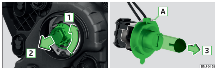
Obr. 190 Výměna žárovky dálkového světla
