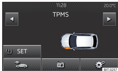
Obr. 127 Tlačítko pro uložení tlaků / Příklad zobrazení na displeji: systém upozorňuje na změnu tlaku v levé přední pneumatice
