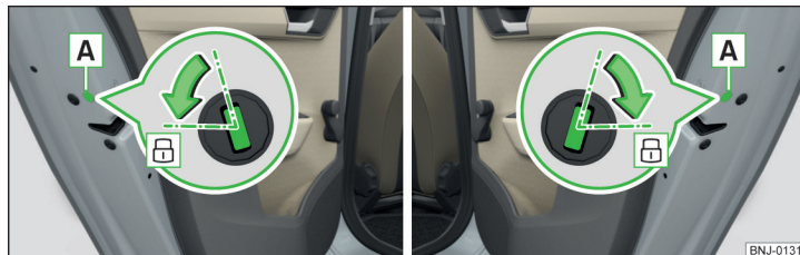
Obr. 173 Nouzové zamknutí: zadní dveře levé/pravé
