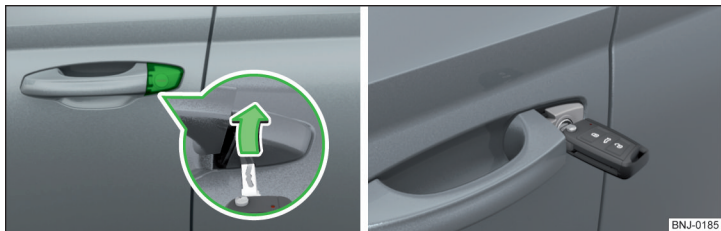
Obr. 172 Klikla dveří řidiče: zakrytá vložka zámku / vložka zámku s klíčem
