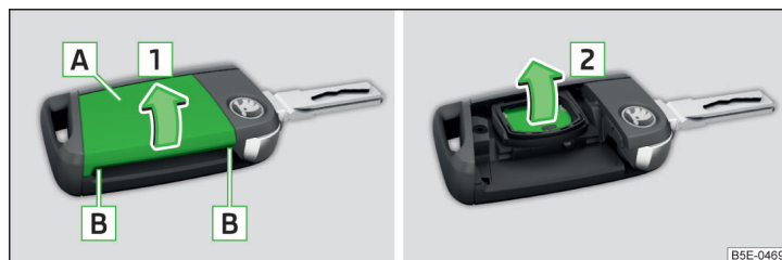
Obr. 171 Demontáž krytu / Vyjmutí baterie
