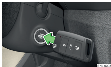
Obr. 107 Startování motoru - stisknutí tlačítka klíčem
