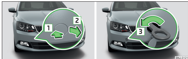
Obr. 169 Demontáž krytky / Montáž vlečného oka
