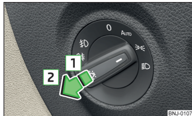
Obr. 44 Spínač světel: zapnutí mlhových světlometů a zadního mlhového světla
