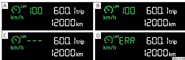
Obr. 121 Segmentový displej: příklady zobrazení stavu speedlimiteru
