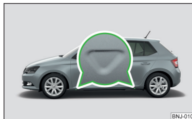
Obr. 162 Upínací body pro nasazení zvedáku vozidla
