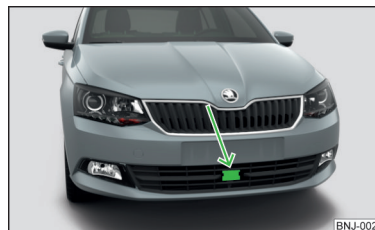
Obr. 123 Umístění radarového snímače
