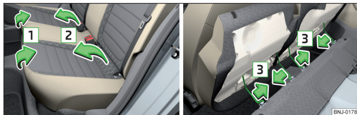
Obr. 60 Vyklopení sedáku / Vyjmutí děleného sedáku
