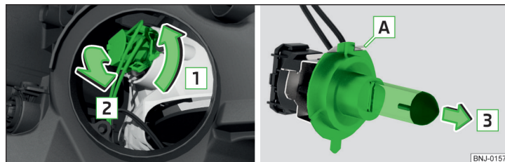
Obr. 189 Výměna žárovky potkávacího světla
