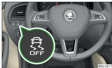
Obr. 113 Tlačítko systému: deaktivace/aktivace ASR
