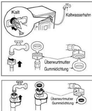
► Diese Maschine ist auf einen Wasserdruck von 100 kPa bis 1000 kPa ( $1.0 - 10 \text{ kg/cm}^2$ ) ausgelegt.
