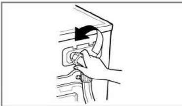
**2.** Den Wasserzulaufschlauch abschrauben.
