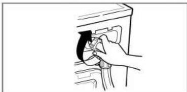
**4.** Den Wasserzulaufschlauch anschrauben.
